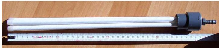
**Figura 2.2.** Módulo de membranas (MEMOS®, Alemania)
