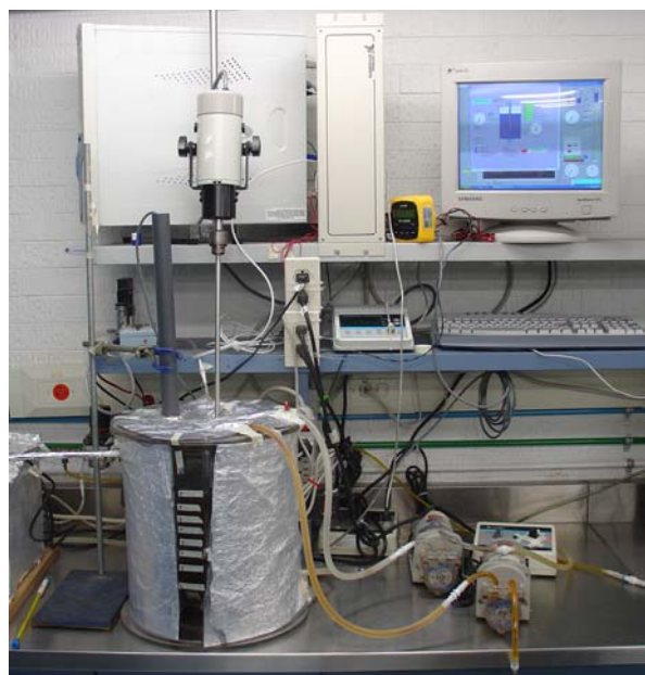
Figura 2.3 Fotografía del reactor anaerobio/aerobio
