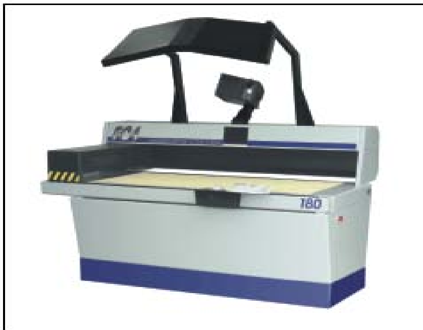
Figura 1.13: Máquina FC4180. Area útil: 1800 x 600 mm. Velocidad: 40 cm/seg. Peso: 1100 Kg. Dimensión: 2.1 x 1.4 x 2.2 m.
