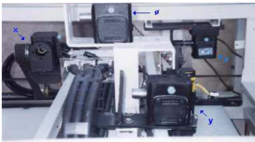
Figura A.8: Reductores de los eslabones ( x, y, z, \phi ) con relación 10:1.
