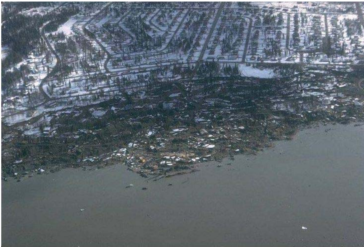
Figura 1.2 Deslizamiento de tierra ocasionado por licuación (terremoto de Alaska, 1964)
