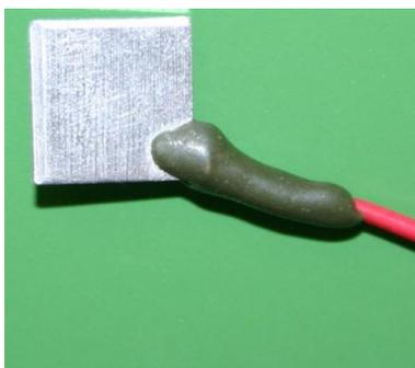
**Figura 3 Muestra de la placa de aluminio utilizada en el tratamiento de conversión a 40 y 65 °C**
