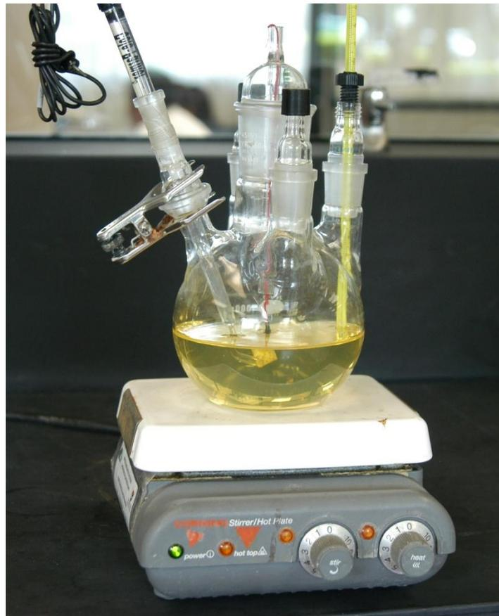
Figura 2 celda de vidrio de cinco bocas, utilizada en el tratamiento de conversión aplicado a 40 y 65 °C
