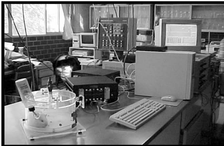
Fig.3. Sistema de pletismografía para animales en libre movimiento
