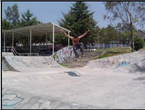
**Ilustración 6.5** Transiciones angulares y curvas entre primer y segundo nivel **(c)**. Tercer nivel compuesto por paramento curvo y plano precedido por transición angular empleada como botador **(d)**. Fotos tomadas jun. 2004 por Ithel Ruvalcaba.
