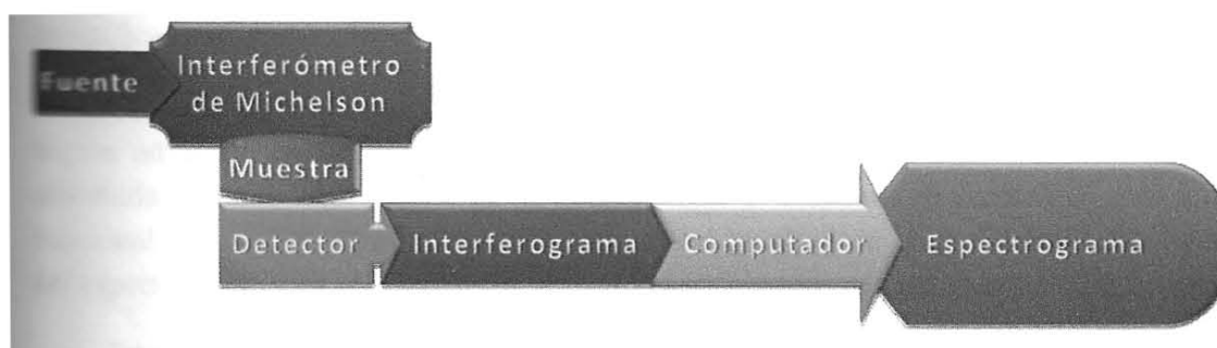
Figura 11 Esquema de un infrarrojo con transformada de Fourier con interferómetro de Michelson.
