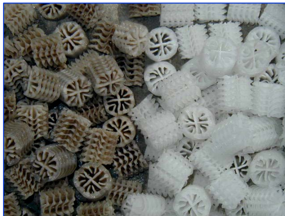
Figura 2.9. Material de soporte (empaques) empleado en sistemas MBBR
