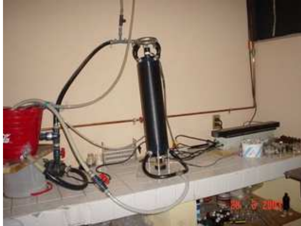
Figura 2.1: Reactor fotocatalítico Photo-CREC-Water II, Universidad Autónoma de Zacatecas
