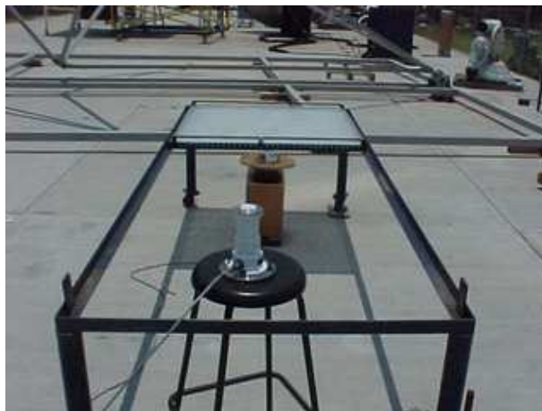
Figura 5.4: Radiómetros empleados en la experimentación, debajo del reactor radiómetro-CIE y en el banco radiómetro-UNAM
