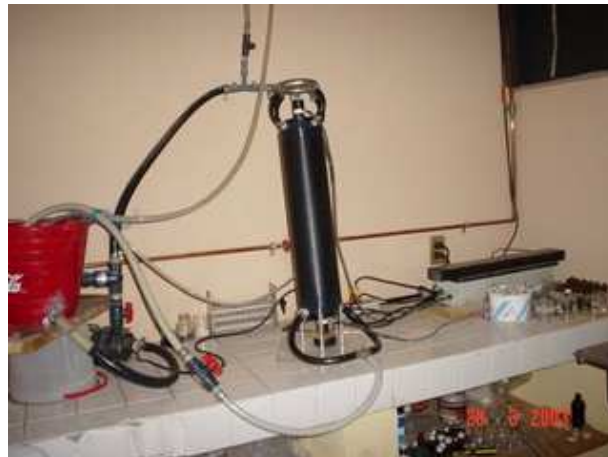
Figura 4.3: Reactor fotocatalítico Photo-CREC-Water II ubicado en la facultad de ciencias químicas en la Universidad Autónoma de Zacatecas
