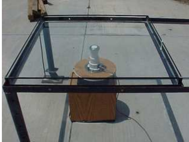
Figura 5.3: Reactor de Placa Plana con un Espesor de Vidrio de 3 mm
