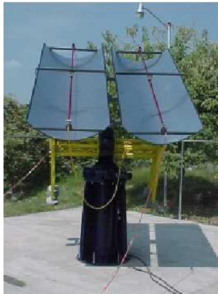
Figura 2.2: DICEF (Dispositivo concentrador para el estudio de la fotocatalisis). Centro de Investigación en Energía (CIE).
