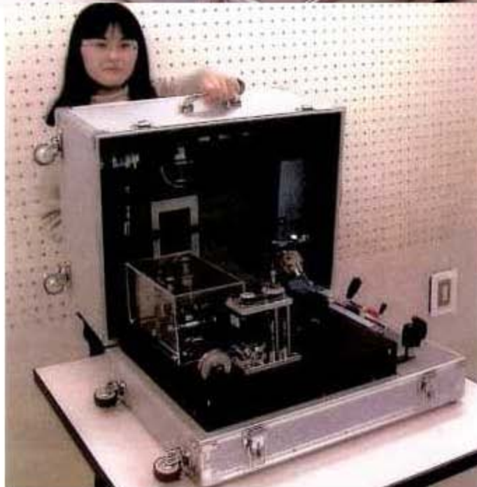
Figura 1.9 Microfábrica sobre mesa desarrollada en MEL
