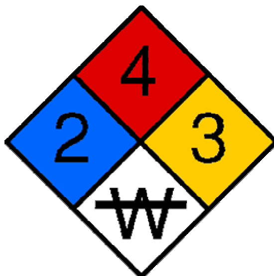
FIG.1 DIAMANTE DE PELIGRO DE LA NFPA. El rombo azul identifica el riesgo para la salud. El rombo rojo indica el riesgo por inflamabilidad. El rombo amarillo señala el riesgo por reactividad o inestabilidad. El rombo blanco indica riesgos especiales tales como: W reactivo al agua, COR corrosivo, AIR reactivo al aire, OXY oxidante. (16, 17, 18, 19, 20)
