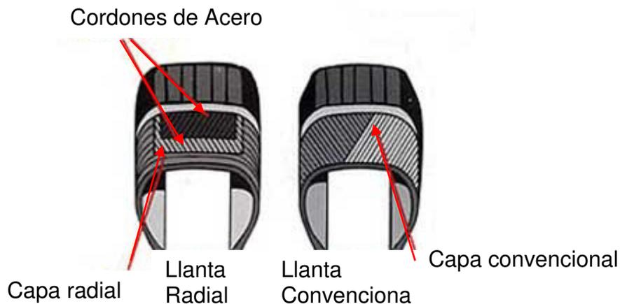
**Figura 2.12 Llanta radial y convencional**
