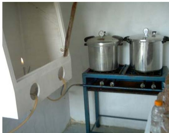
Foto 15 ollas de precisión para esterilizar.
