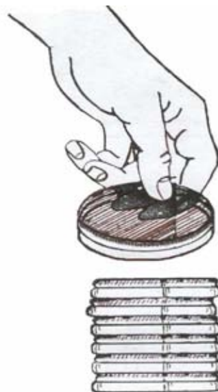
Figura 5. Forma en que deben de ser colocadas las cajas petri para prueba de esterilidad en la incubadora.
