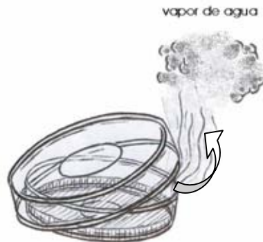
Figura 2. Abertura que debe tener la caja petri, para la salida del vapor de agua. Evitándose con esto, la formación de gotas de rocío.
