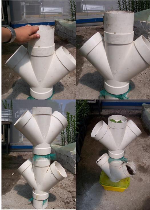
Ensamblado de la columna de cultivo (Y de PVC)
