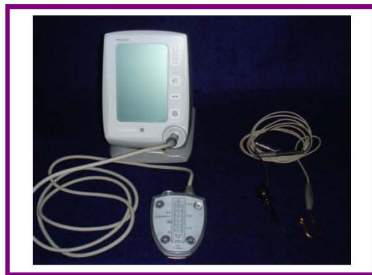
Fig 18. Localizador de ápice de cuarta de generación (Elements Diagnostic, SybronEndo, Orange CA).
