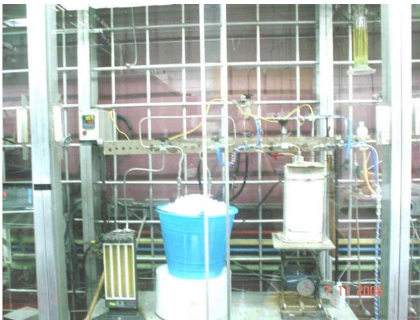
Figura 21. Instalación del equipo para el proceso de carbonización.
