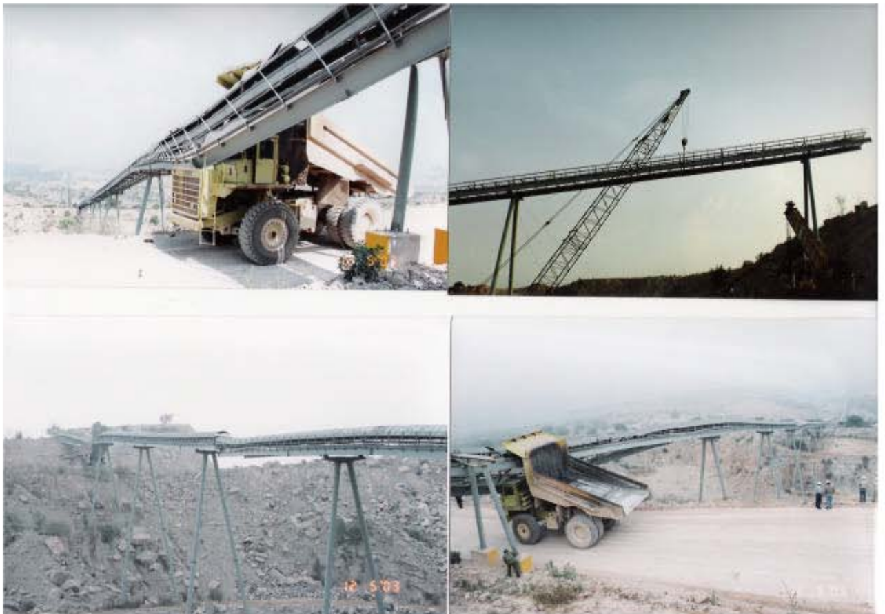
Fotos durante el día del percance en el que el camión dañó la banda
