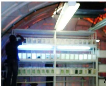
**Figura 7.** Sistema de recirculación cerrado diseñado para el mantenimiento y reproducción en cautiverio de camarones carídeos. Los camarones experimentales se mantuvieron individualmente en cada acuario.
