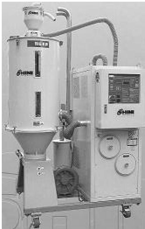
*Figura 6.4.- Equipo de des-humidificación de aire.*
