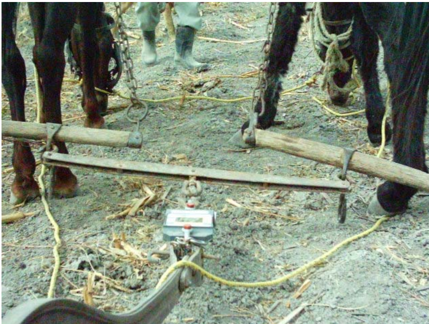
Fig. 11 Punto de enganche del dinamómetro digital con la vara de guardia y el arado.
