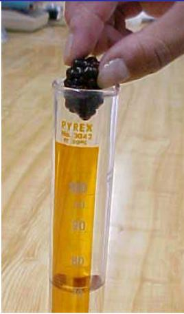
Figura 25. Método práctico para medir el volumen de los frutos en una probeta graduada.
