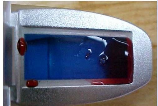
Figura 30. Medición de sólidos solubles totales con el refractómetro manual ATAGO N-1aBx.
