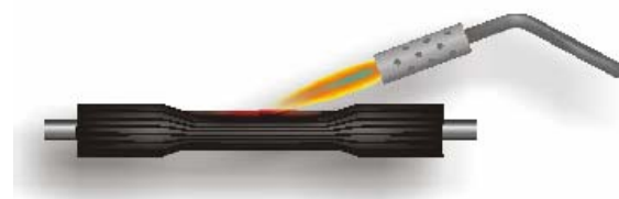
FIGURA 25. EMPALME TERMOCONTRÁCTIL MT
