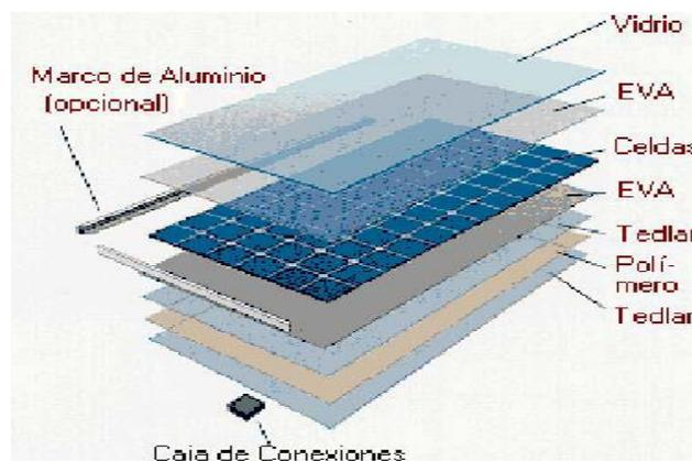
Figura 7.2.3. Partes que integra el sistema fotovoltaico
