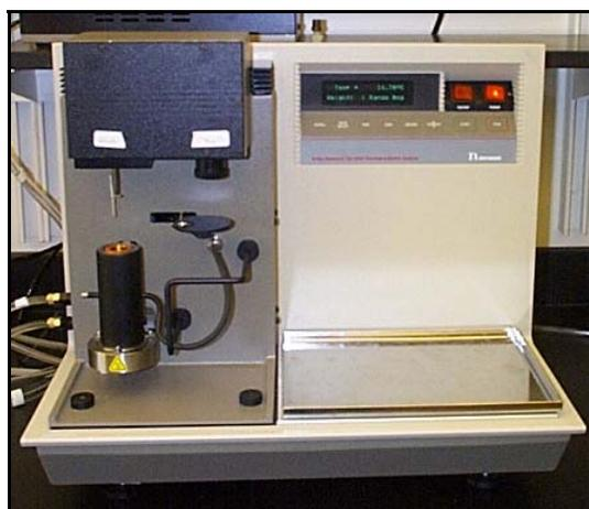
**Figura 2.10** Analizador Termogravimétrico TA Instruments modelo 2950.
