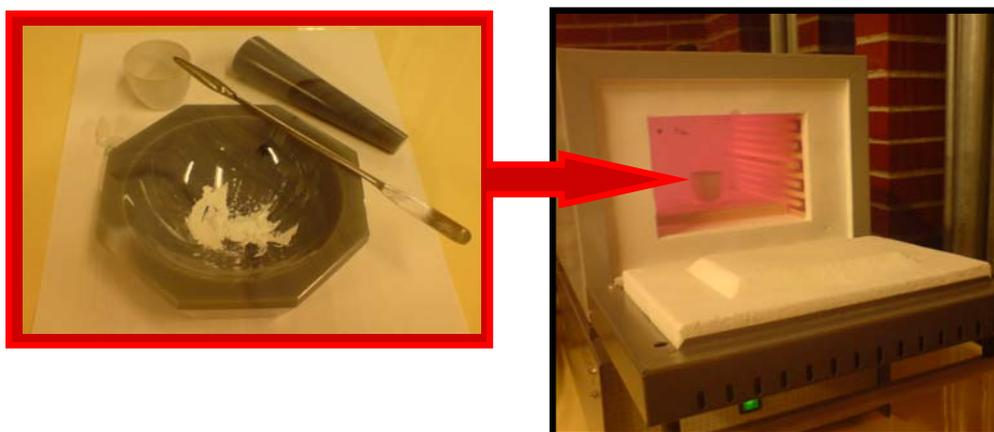
Figura 2.2 Procedimiento experimental de molienda y calcinación en mufla.
