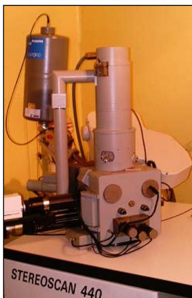
**Figura 2.7** Microscopio Electrónico de Barrido Cambridge Stereoscan 440.
