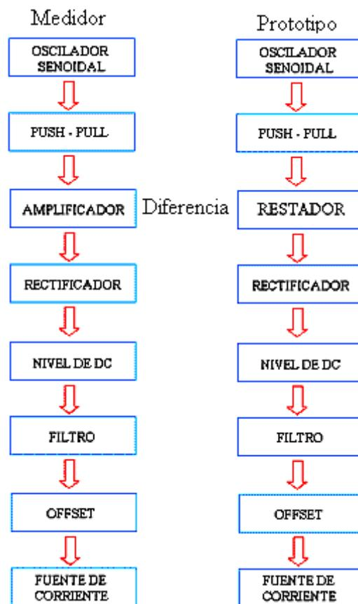
**Diagrama de bloques del medidor y del prototipo.**
