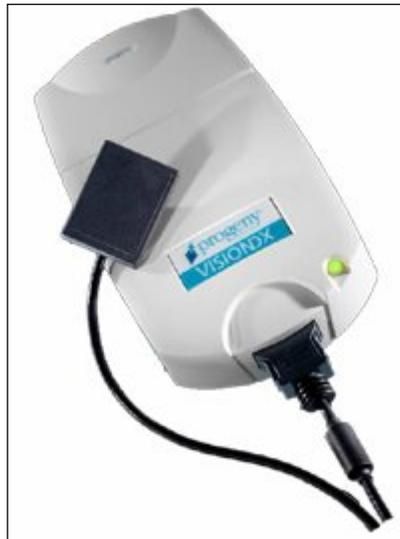
Fig. 6 Radiovisiógrafo digital<sup>8</sup>
