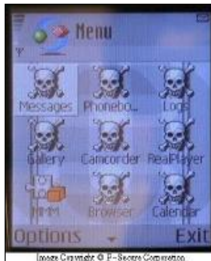
Figura 20. Imagen del menú afectado por el virus Skulls en un equipo Nokia con SO SYMBIAN
