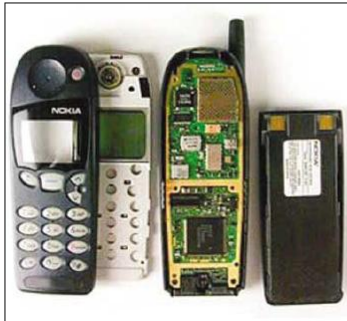
Figura 5. Nokia 5120. Vista de los componentes internos de un equipo analógico.
