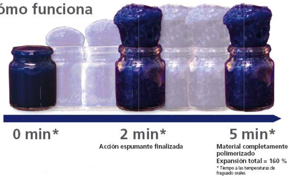
Figura 11. Expansión del Magic Foam Cord. 16
