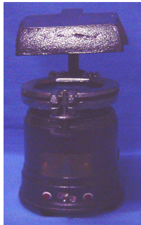
Fig.4 Cámara de vacío o Vacuumm
