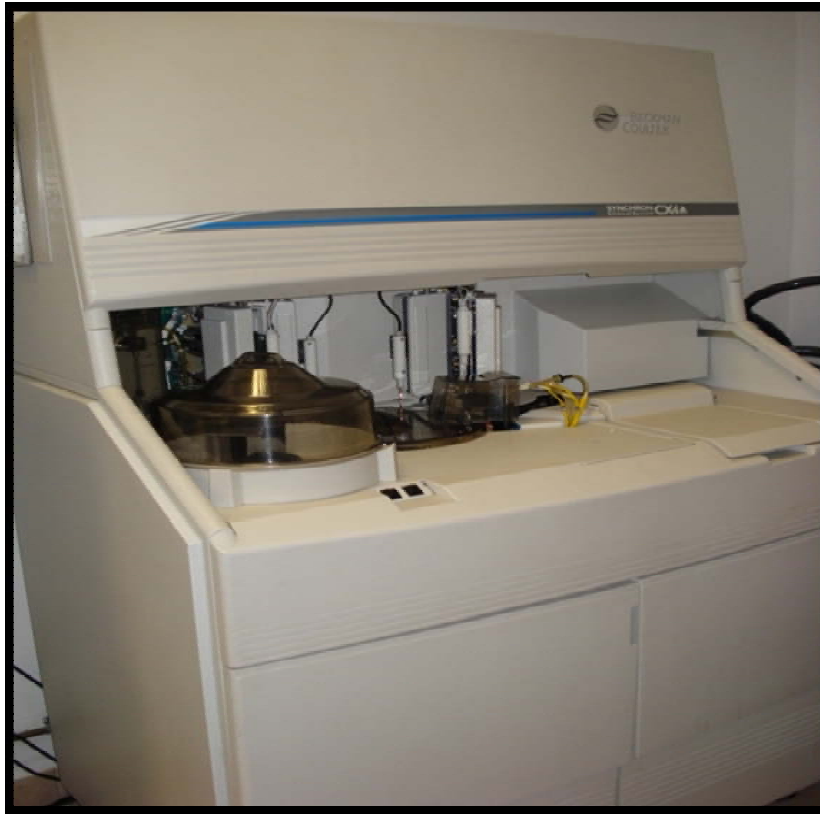
FIG.10. CX4 Equipo para química clínica
