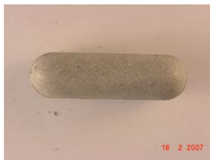
Fig. 22 de Bolos de Liberación prolongada placebo obtenidos por granulación húmeda
