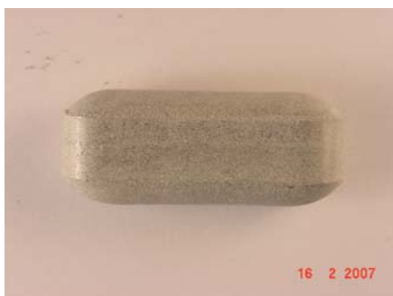
Fig. 22 de Bolos de Liberación prolongada placebo obtenidos por granulación húmeda
