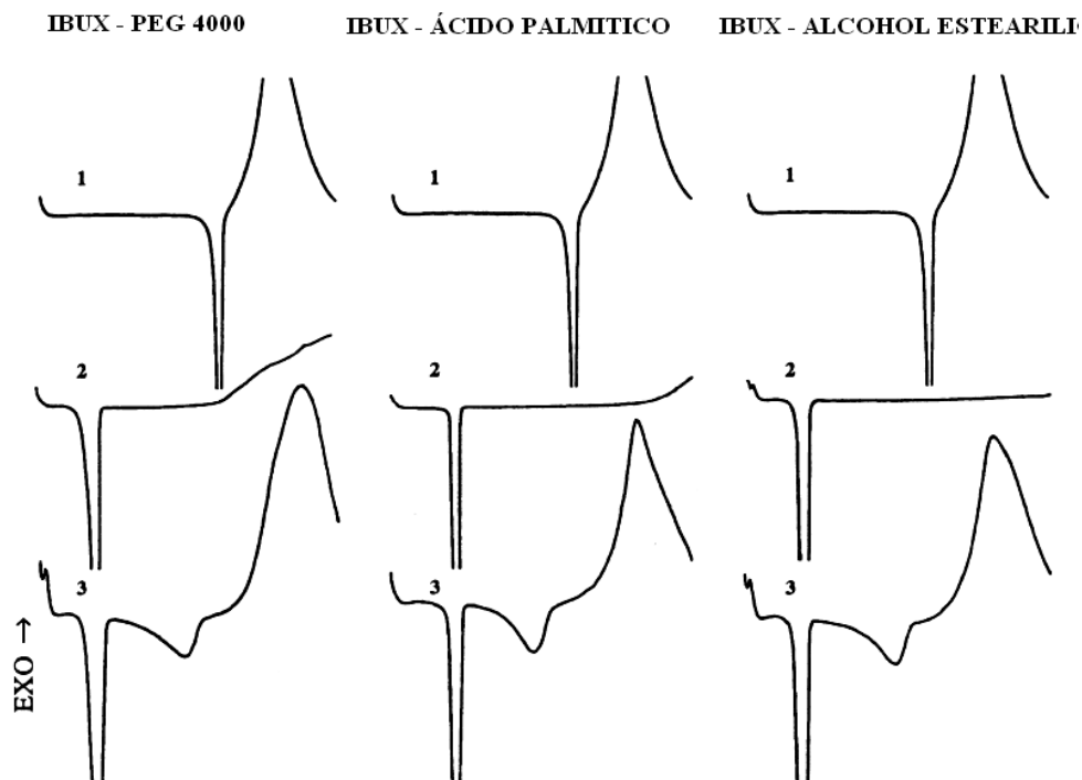
Figura 81. Curvas DSC de Ibuproxam (IBUX) y sus respectivas mezclas con excipientes. (1) IBUX; (2) Excipiente y (3) mezclas fármaco-excipiente 1:1.
