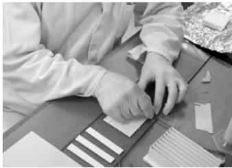
3. Después se colocan las tiras cortadas de nitrocelulosa en el recipiente carrilero y se bloquean con 1000  $\mu\text{L}$  de **Buffer de Bloqueo<sup>B</sup>** por carril o por tira de nitrocelulosa, e incubar por 60 minutos en agitación constante.
