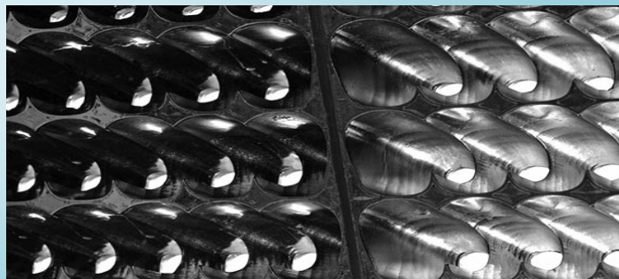
Figura 14.2: fotografía tomada por detrás de la abertura de salida del dispositivo. Una celda brilla solamente si la vista es parte de la dirección del sector angular
