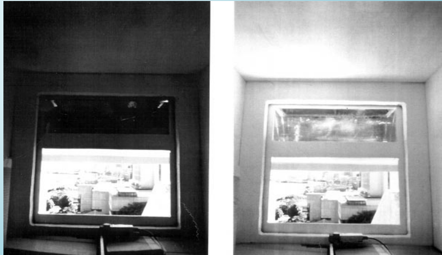
Figura 8.3: Compara la luz natural en un cuarto de prueba con una persiana convencional (izquierda) y una persiana guiadora de luz (derecha). El otro borde de la persiana es una banda horizontal amarilla para reducir el área de la ventana.
