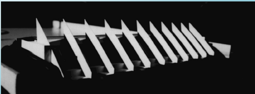
Figura 13.1: Modelo a escala de una abertura cenital anidólica localizada en un tejado
