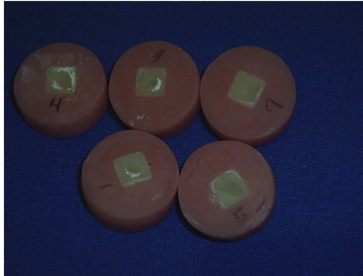
5. FALLA COHESIVA EN MUESTRAS DE RESINA
