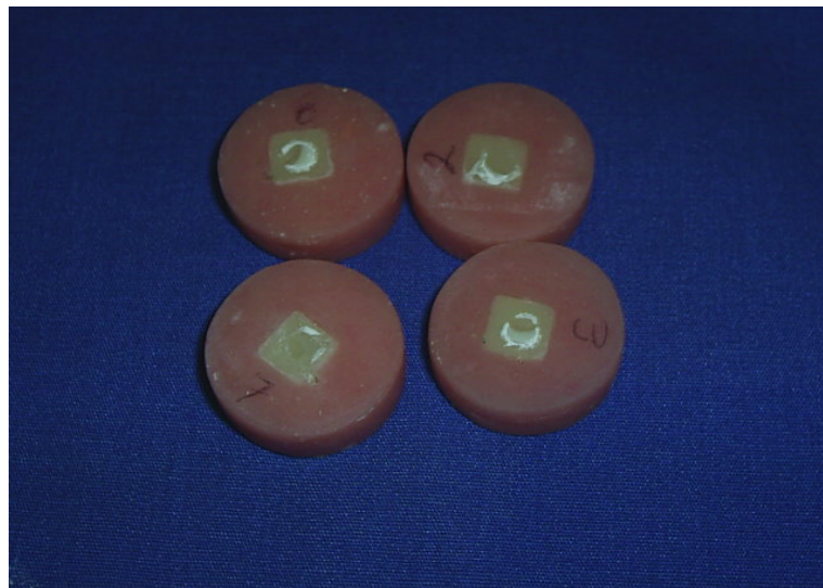
1. FALLA ADHESIVA EN MUESTRAS DE RESINA
