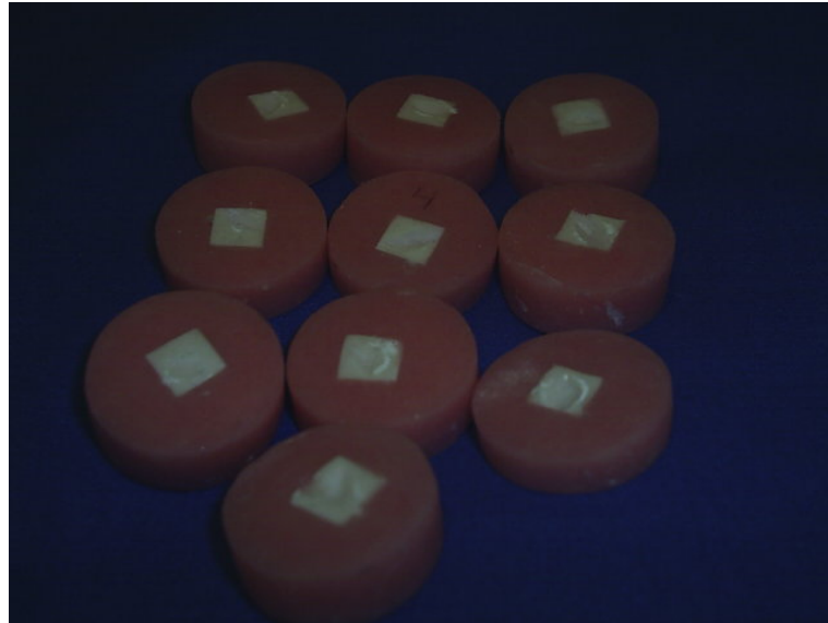
2. FALLA COHESIVA EN MUESTRAS DE CERÁMICA
