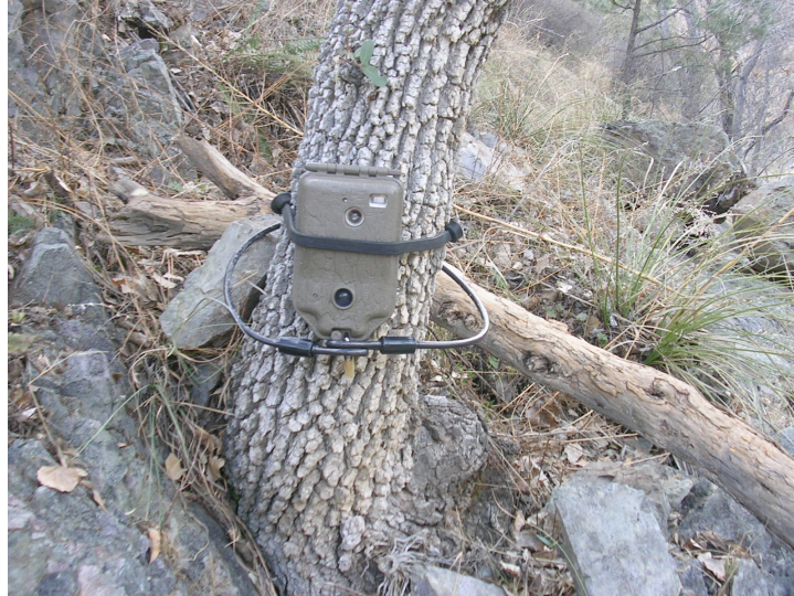
Foto 1. Colocación de una cámara Deercam en el tronco de un árbol.
