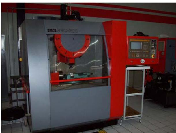
Figura A3.3 Máquina de control numérico *EMCO VMD-300*
