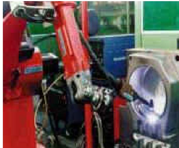
Figura 1.2a Robot Soldador usado en la Industria Automotriz [1]
