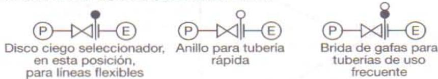
TIPO B. PARA FLUIDOS PELIGROSOS CON VENTEO DESTINADO A COMPROBAR EL AISLAMIENTO
