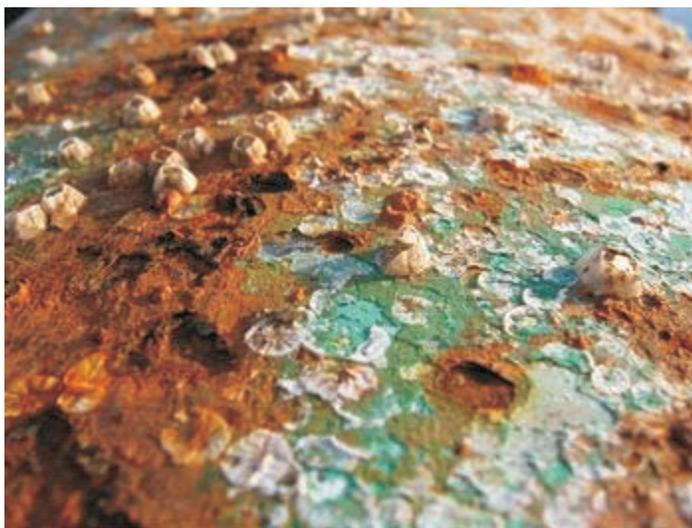
Figura 2.7 En esta imagen podemos observar con claridad la formación de óxido de hierro en la superficie del metal, y a diferencia de los respectivos óxidos de aluminio y titanio, este es muy poroso y la capa que forma se desprende fácilmente.
