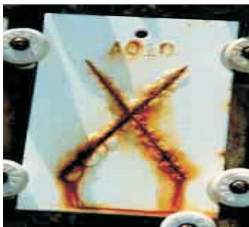
Figura 2.8 Probeta metálica sobre la cual se realiza una evaluación de un recubrimiento anticorrosivo de acuerdo a normas estandarizadas.
