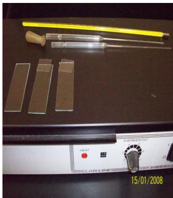
Fig. 26 laminillas, cubreobjetos, pipetas pasteur y termómetro sobre platina a 37°C.
