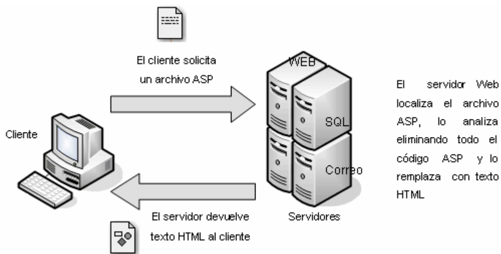
Figura 2.3.1 Interacción cliente/servidor para archivos ASP
