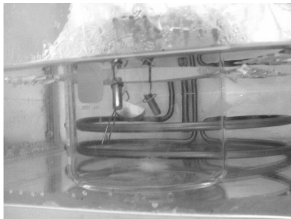
Figura 4.7. Aspecto final de las probetas niqueladas.
