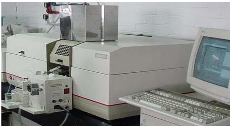
**Figura 5. Espectrofotómetro de absorción Atómica con sistema de atomización por generador de hidruros.**
