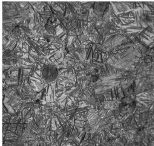
Figura 4.2.4 Ausferrita en un hierro nodular bajo en cobre austemperizado a 927°C por 2 hrs y austemperizado a 316°C por 2 hrs. Imagen de microscopía óptica 500x. Dureza 371 BHN La muestra fue atacada con nital al 2% [36]. Se observan pocas areas de austenita alta en carbono (zonas claras) y muchas agujas de ferrita acicular particularmente cerca de los nódulos de carbono.
