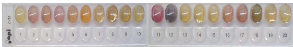
Figura 13. Galería API-Zym con coloraciones indicadoras de las enzimas.
