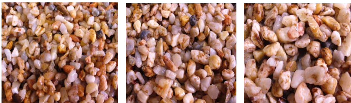
Figura 21. Aspecto del medio de empaque cubierto por biopelícula.
