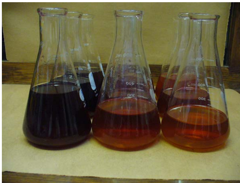
Figura 26. Vinazas tratadas en columnas empacadas con cuarcita.
