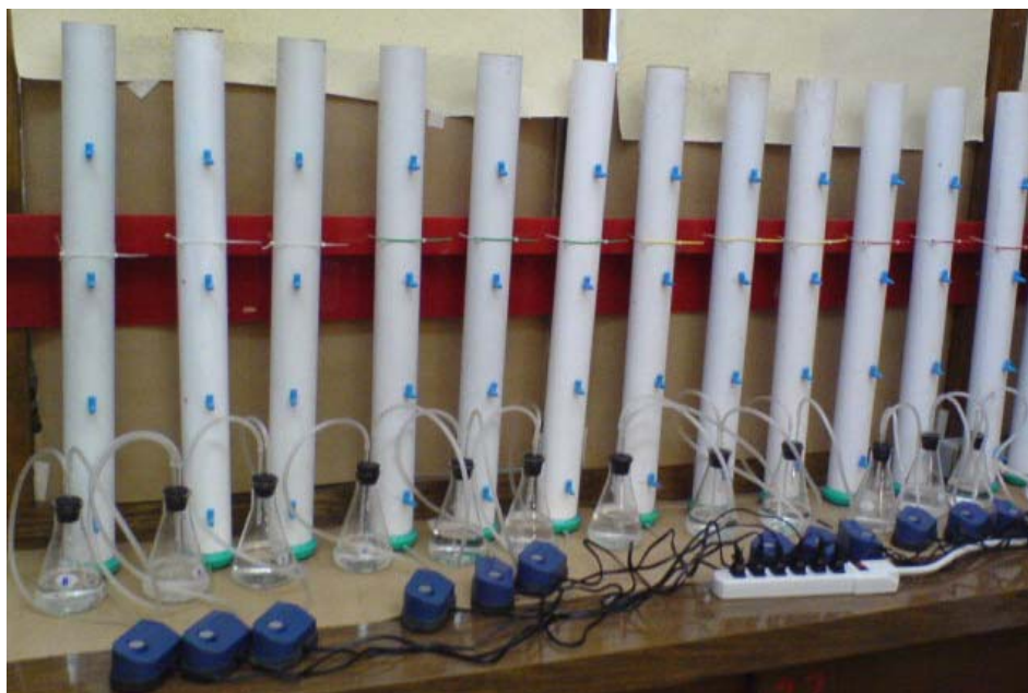
Figura 31. Arreglos de columnas empacadas utilizados.
