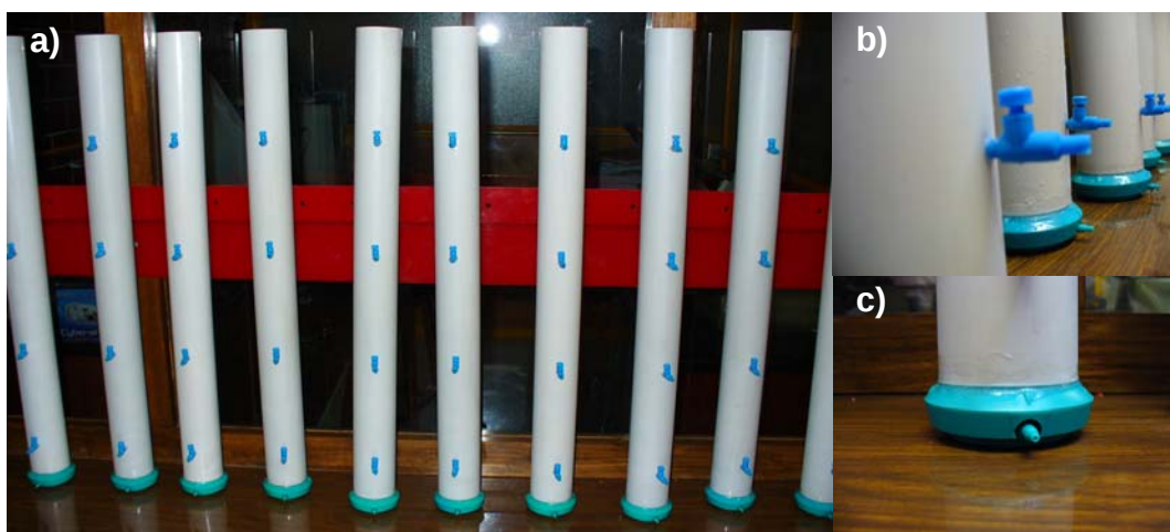
Figura 20. a) Columnas construidas, b) válvulas de muestreo y c) difusor de aire
