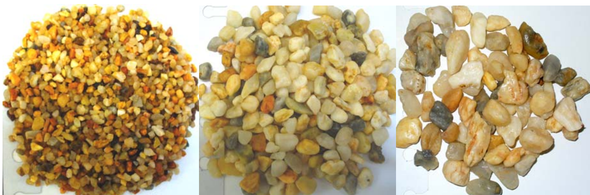
Figura 9. Aspecto de la cuarcita en sus diferentes granulometrías empleadas.
