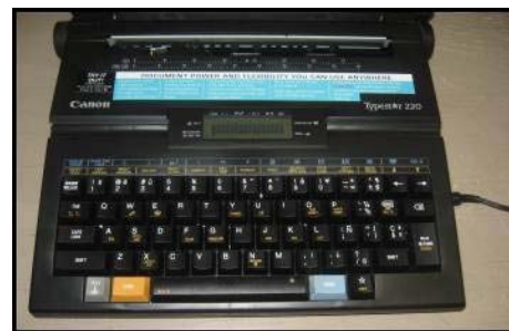
Figura 2.4 Máquina de escribir, Canon, incluye memoria, funciones preprogramadas y LCD.
