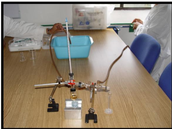
Figura 24. Equipo para Destilación Simple
