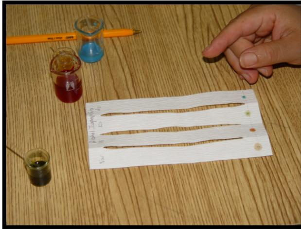
Figura 33. Aplicación de muestra en el papel filtro
