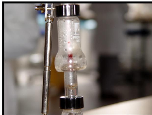
Figura 27. Presencia de gotas del destilado en las paredes de la junta Hickman
