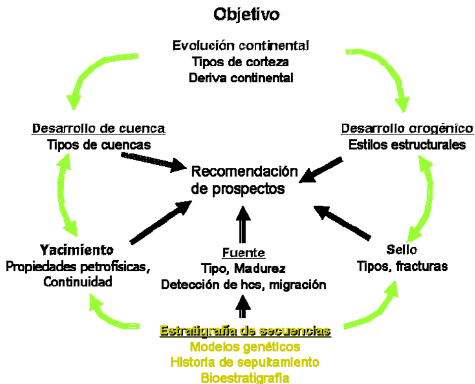
Figura 15.- Factores interrelacionados en la cadena de valores de exploración de hidrocarburos. Tomado de Sangree, Vail y Mitchum (1990).
