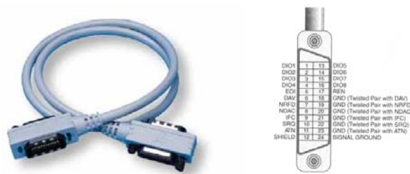
Figura 1. Cable de conexión GPIB: aspecto físico y distribución de señales (americano).
